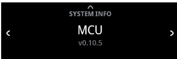
“System Info (系统信息)” 显示有关当前MCU、LCD和FPGA固件版本的信息。
