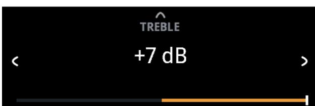
“低音”和“高音”控制只影响低频和高频段的音频强度，而使重要的中频段不受影响。
