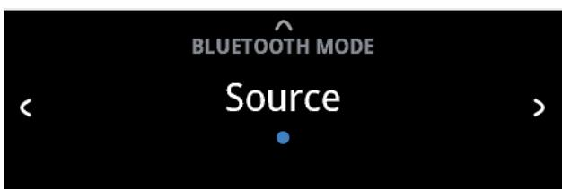
将“Bluetooth Mode (蓝牙模式)”设置为“Source (输入源)”。确保蓝牙天线连接到后面板上的蓝牙天线端子。
