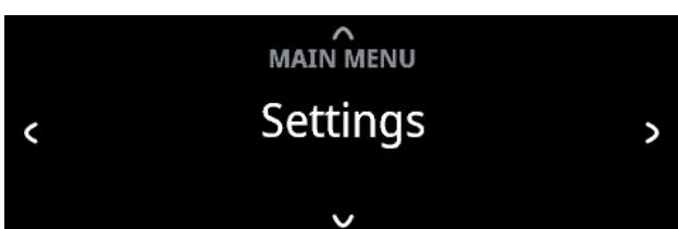
按下前面板[▼]按钮一次，主菜单选项将出现在显示屏中。使用前面板[<或>]按钮通过主菜单选项进行选择-**Settings**, **Source Setup**（设置、源设置）和**System Info**（系统信息）。
