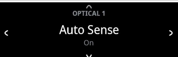
可以为每个输入源设置Auto Sense（自动检测）。当从特定输入源的输入检测到处于活动状态的输入源时，自动检测功能使特定输入源能够从待机模式中唤醒。
