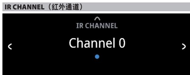
C 399能够通过备用红外通道进行操作。如果您有两个NAD产品可以通过类似的遥控命令进行操作，此功能非常有用。有了备用红外通道，可以通过将每个产品设置到一个不同的红外通道，在同一个区域中独立控制两个不同的NAD产品。
