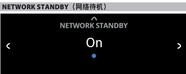
“Network Standby（网络待机）”模式可在待机模式下保持网络连接，并降低系统性能水平。
