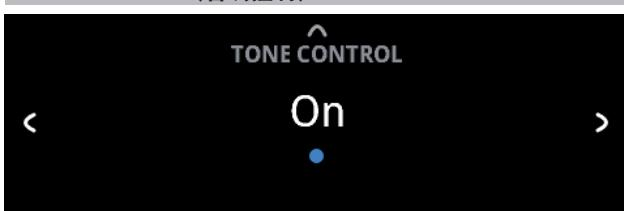
音调控制用于增加或减少特定的音频频率。可以开打或关闭音调控制电平-低音和高音。
