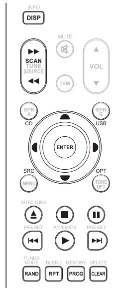
**TUNER CONTROL (调谐器控制) (与NAD AM/FM/DAB调谐器配合使用)**：将“DEVICE SELECTOR (设备选择器)”设定为“TUN”，以使用这些按钮。请参阅遥控器面板上印制的相应标签及其各自分配的按钮，以使用这些功能。以下一些控制按钮仅适用于特定NAD接收器或调谐器型号；请查阅您的NAD接收器或调谐器的用户手册，以了解控制按钮的兼容性。
